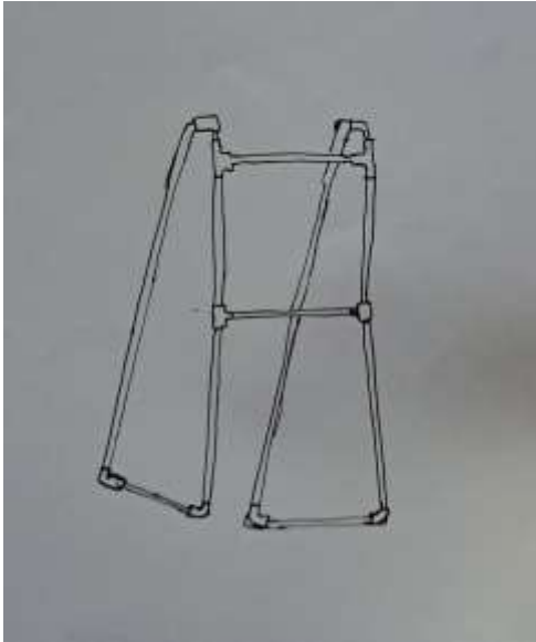
Gambar 1. Desain Produk Penyangga Target panahan
